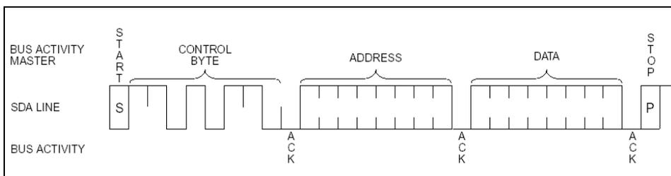
Figure 5.1 – Byte write
